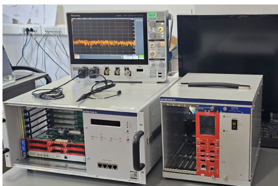
Banc testare detectori (stanga). Modul preluare și procesare semnale digitale (dreapta).
